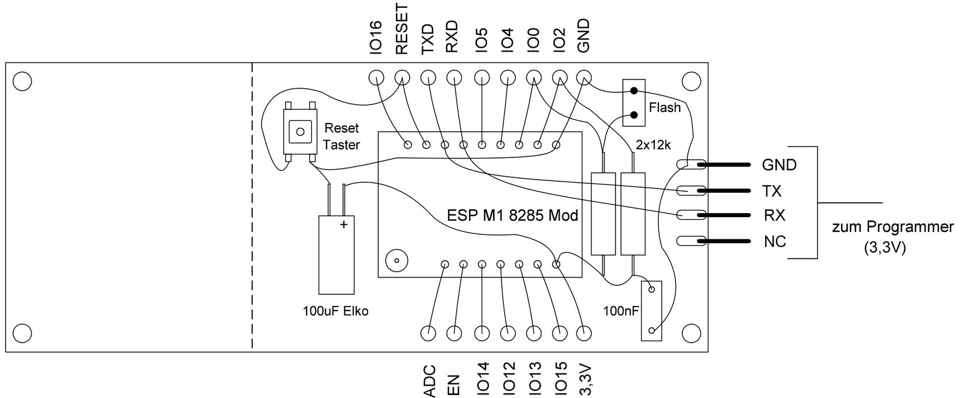
Das ESP-M1-8285 Modul wird auf eine Lochrasterplatine gelegt und mit Kupfer-Lackdraht an die entsprechenden Lötstifte gelötet.
